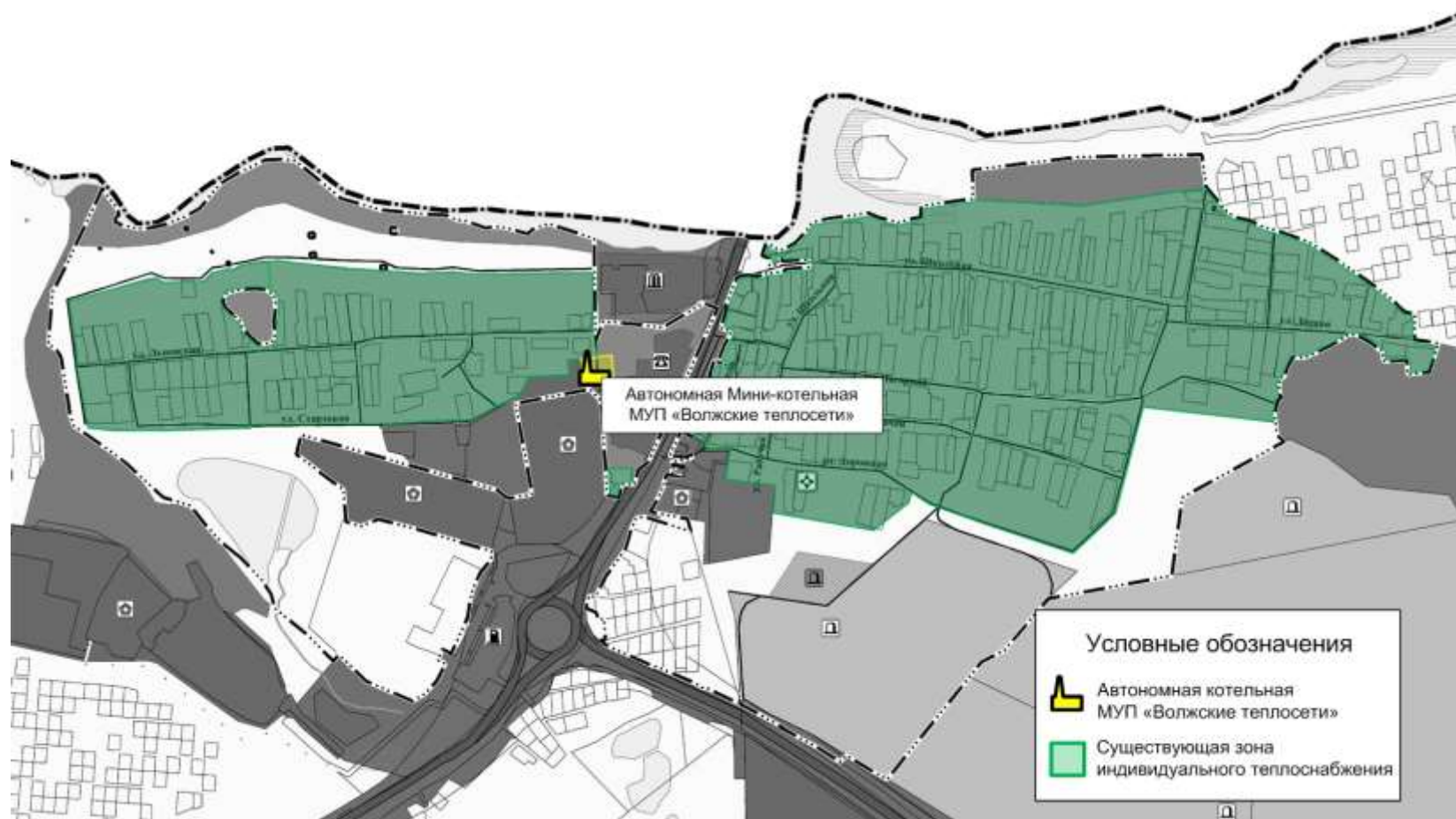
Рисунок 1.1.1.2 – Зона действия автономной котельной, а также индивидуальных источников тепловой энергии, находящихся в частной собственности жителей п. Подстепновка
