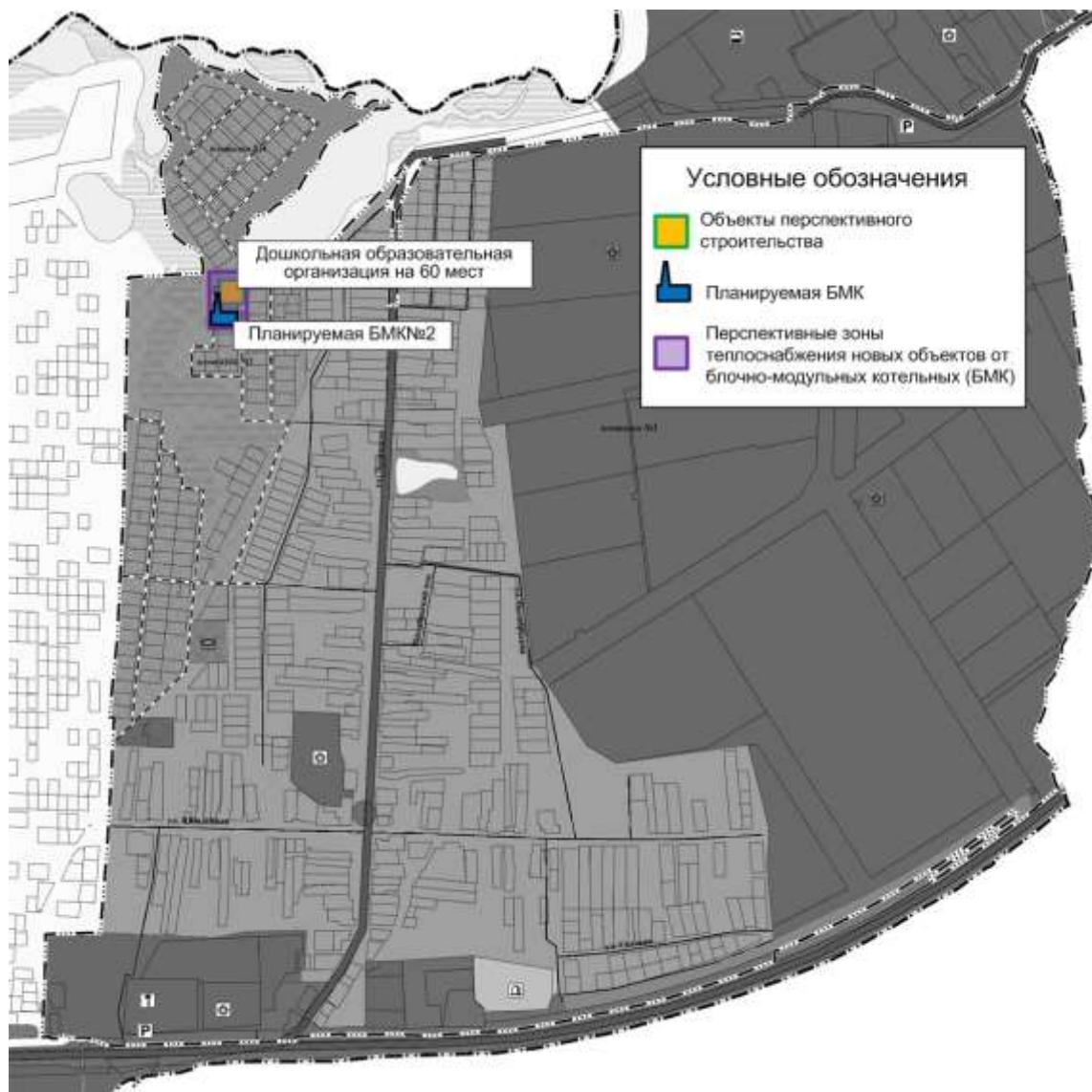
Рисунок 2.4.2 - Перспективная зона теплоснабжения блочно-модульного источника тепловой энергии, планируемого к размещению на территории с. Преображенка
